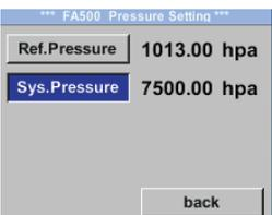
如果要求,传感器也可以在进入压缩空气设备的系统压力和参考压力(大气压力)
